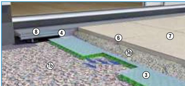
Aqua Drain<sup>®</sup> PRO für die lose Verlegung (s. Technisches Datenblatt)
