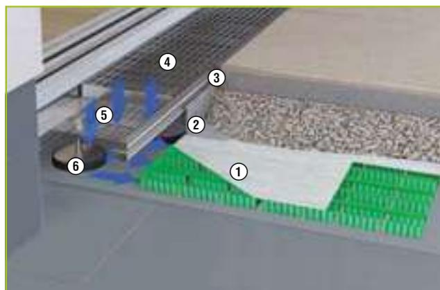
**AquaDrain® FLEX Drainroste leiten Oberflächen- und Fassadenwasser schnell und unbremst in die angeschlossene Flächendrainage ab.**
