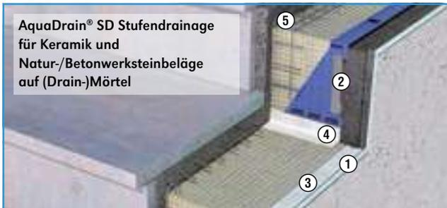
AquaDrain® SD Stufendrainage
