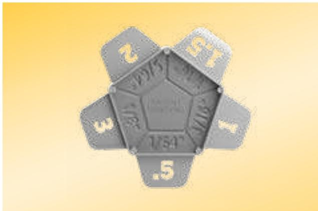
Der IndorTec® FA Fugenabstandshalter sorgt für eine einheitliche Fugenoptik bei kalibrierten, rektifizierten Fliesen und Naturstein. Es sind Fugenbreiten von 0,5 bis 3 mm möglich. Durch Kombination von zwei Fugenabstandshaltern sind Fugenbreiten bis 6 mm möglich. Mit einer Abstufung von 0,5 mm gewährleistet der Fugenabstandshalter ein gleichmäßiges Fugenbild.
