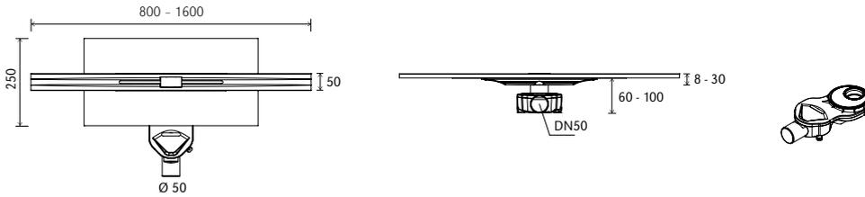
**Aufbauhöhe 80 - 120 mm – waagerechter Ablauf – 1,05 l/s Ablaufleistung – Sperrwasserhöhe 50 mm**
