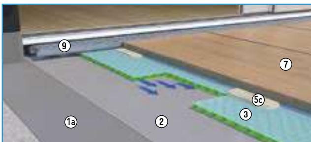
Aqua Drain<sup>®</sup> PRO für das punktweise Verlegesystem
