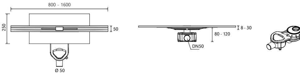
**Aufbauhöhe ab 20 mm – senkrechter Ablauf – 1,43 l/s Ablaufleistung – Sperrwasserhöhe 32 mm**
