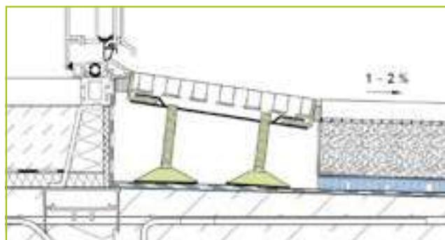
Aqua Drain® BF-FLEX ermöglicht den Einbau als variabel einstellbare, rampenartige Schräge, sodass die Oberkante der am Türelement angeflanschten Abdichtung nicht mehr unter der Oberkante des Belages liegt. Ergebnis: Hinterläufigkeit der Abdichtung durch Rückstau wird ausgeschlossen.
