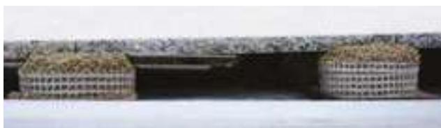
Spezielle Höhenausgleichsringe dienen als Schalung für den Mörtel. Die 27 oder 50 mm hohen Ausgleichsringe können problemlos mehrfach übereinander gesetzt werden. Damit ist der Höhenausgleich von bis zu 150 mm möglich. So lässt sich das Belagsgefälle einfach einstellen (siehe [www.gutjahr.com/techniktipp](http://www.gutjahr.com/techniktipp)).
