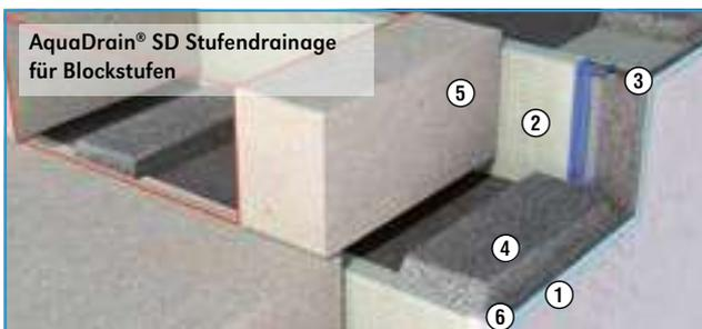
AquaDrain® SD Stufendrainage
