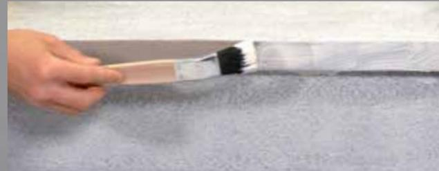
**Sofortige Anfangshaftung nach Trocknung.** Die getrockneten Klebstoffflächen werden mit kurzem, hohem Druck aufeinandergepresst, wodurch eine Verfilzung entsteht und der Klebstoff unmittelbar und extrem stark haftet.
